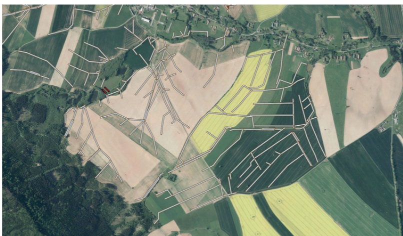
Obr. 4: Hlavníky (odvodňovací trubky) na území povodí Křinického potoka.
